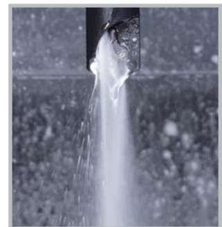
• Kühlung kann direkt durch den Bohrer auf die Wendeplattenspitze geführt werden
