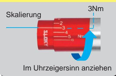
3. Lassen Sie den Adapter los. Er fährt automatisch auf die Position "0" zurück.
